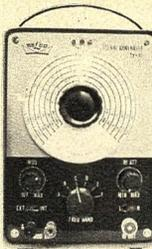
Frequenz-Bereich: 100 kHz bis 150 MHz in 6 Grundwellenbereichen, 120 MHz-300 MHz mit Oberwellen
