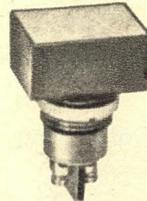
**Modell 1.10101, Domino**. Okape-Kappe, Beschriftungsmöglichkeit durch Gravur, Gehäuse, Taste und Aufsteckkappe Makrolon, Gewinde ring Aluminium. Für 1 Stromkreis 2 A/250 V~. Einbau- $\phi$  15,5 mm.
