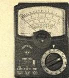
**FT/2 Multitester, 21 Meßbereiche mit Überlastungsschutz. Innenwiderstand: 20 000 Ω/V=, 10 000 Ω/V~. Bereiche Gleichspannung 0-2500 V, Wechsel-Spg. 0-1000 V, Gleichstr. 0-250 mA, Widerst.: 0-6 MΩ, Kap.: 0,01-0,3 µF. M.: 150 x 83 x 29 mm, Gew. 250 g 36.50**
